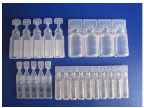
塑料安瓿瓶在使用过程中需要具有一定的开启力/拧开力,如果开启力/拧开力太小的话,在药品流通环节容易造成泄漏的情况,所以需要对开启力/拧开力进行测试,避免这个问题出现
