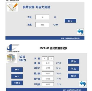
3、测试完成后,系统自动给出测试的最大最小平均值,并且可以查询每次的测试数据。
