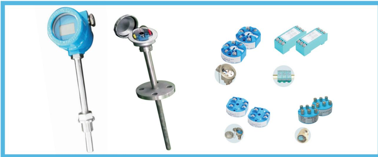
一体化温度变送器主要由温度传感器（热电阻或热电偶）与二线制温度模块（标准型或智能型）构成。显示型产品另加一电流显示表（模块指针或数字显示表）。温度模块及显示表可直接装在传感器的接线盒内，或分离安装在现场管道上，从而使温度的传感、变送及显示一体化。
