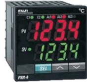
10. 数字输入控制功能(选件): 通过一点开关量ON/OFF, 可改变设定值SV, 控制动作起/停, 斜坡/保温控制的开始/复位, 自动调节功能的起/停, 报警锁存的复位, 定时器计时开始
