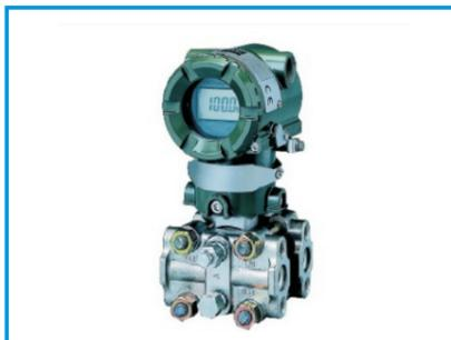
EJA110A型高性能差压变送器采用单晶硅谐振式传感器技术，适用于液体、气体或蒸汽的流量以及液位、密度和压力测量。多传感器技术提供先进的诊断功能，可以检测脉冲线路堵塞或伴热管道的破损等异常。
