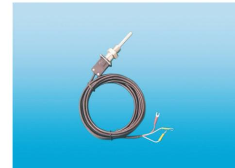
WZPK系列温度传感是针对压缩机行业中所生产的螺杆式压缩机专门研制开发的。选用进口热电阻元件。探头材料选用SUS304不锈钢。产品具有测温准确、抗冲击、耐震动、防漏油、无漂移、使用寿命长等特点。
