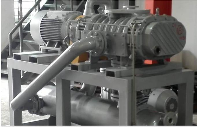
DVQB 高压差机械增压泵，是在普通罗茨真空泵的基础上增加了旁路气体冷却系统而设计的，采用三叶转子实现在气体排出前被回流气体冷却。由于其特殊的结构设计，使其可以在高压差下长期可靠运行。
