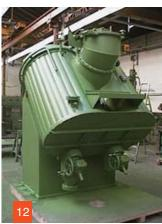
带有真空装置的爱马克倾斜混捏机 被用来作为糊状物料的脱泡干燥机 和在真空条件下混合物料。
