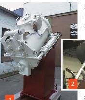
这种叶片的运行模式缩短了混合 速度,通常混合时间不到5分钟, 却能带来高质精准的混合效果。
